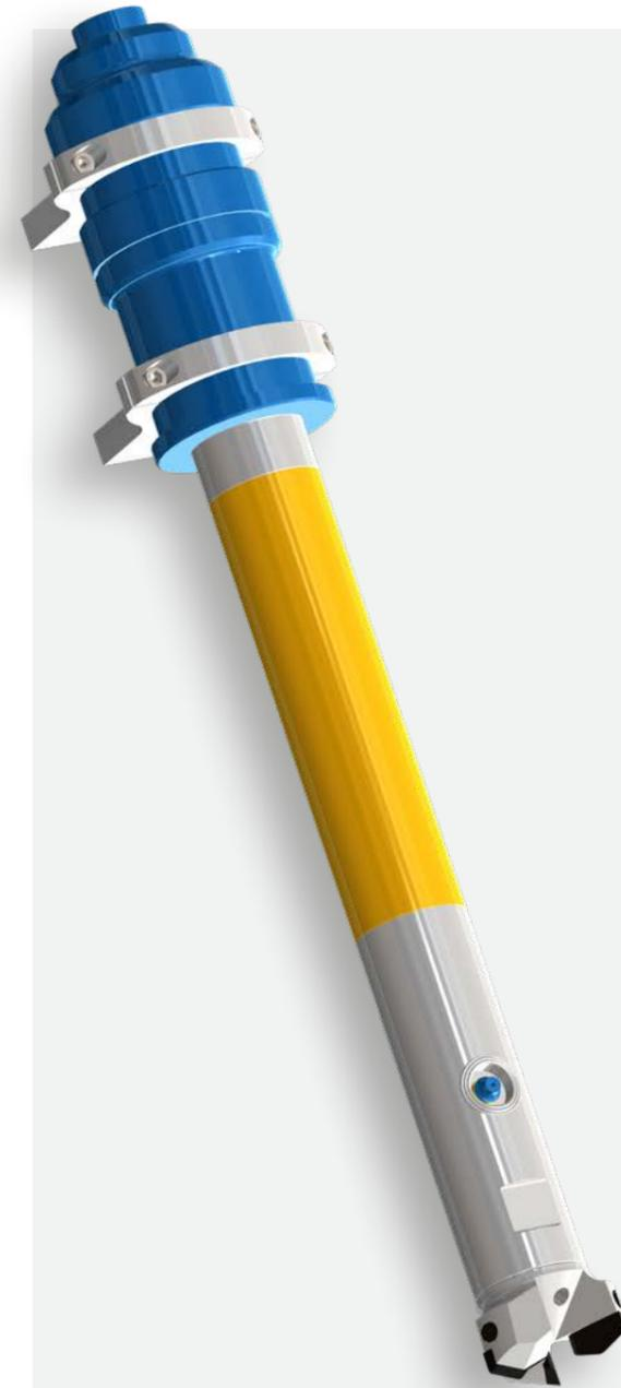
Dieses Bohrsystem wird durch Baugrundinjektionen zum Erstellen von Zement-Bodengemisch-Körpern im Erdreich verwendet. Ziel ist die Verbesserung des Baugrundes, beispielsweise Verfestigungen, Unterfangungen oder Abdichtungen. Hierbei wird die Bodenstruktur mit einem Düsenstrahl von 100 bar bis ca. 600 bar aufgeschnitten. Die Bohrwerkzeuge sind für diese hohen Drücke konzipiert.
