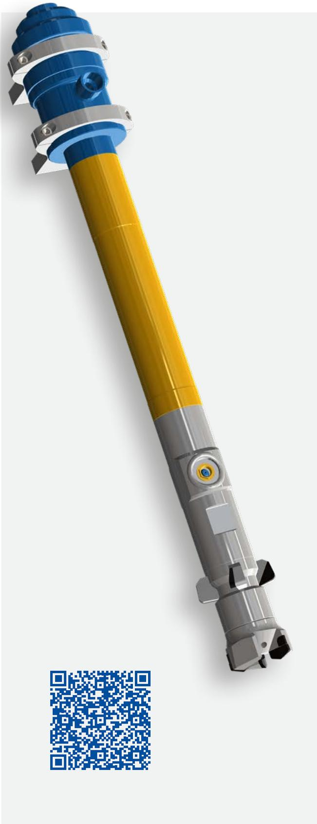
**Dieses Bohrsystem wird durch Baugrundinjektionen zum Erstellen von Zement-Bodengemisch-Körpern im Erdreich verwendet. Ziel ist die Verbesserung des Baugrundes, beispielsweise Verfestigungen, Unterfangungen oder Abdichtungen. Hierbei wird die Bodenstruktur mit einem Düsenstrahl von 100 bar bis ca. 600 bar aufgeschnitten. Die Bohrwerkzeuge sind für diese hohen Drücke konzipiert.**
